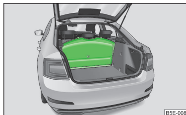
Илл. 87 Укладка полки багажного отсека за спинкой заднего сиденья
