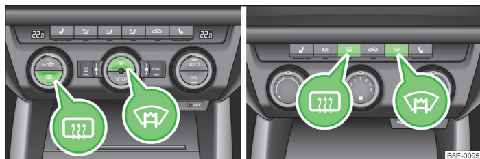
Илл. 40 Кнопки обогрева ветрового и заднего стёкол Climatronic/климатическая установка с ручным управлением, отопитель
