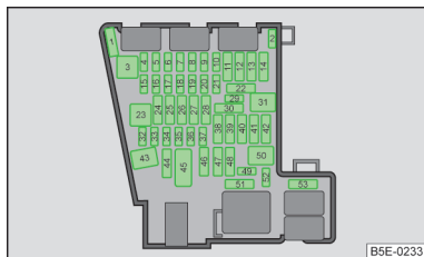
Илл. 215 Схематическое изображение блока предохранителей
