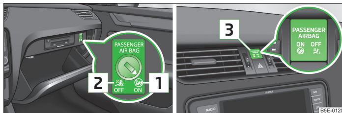
Илл. 171 Выключатель с замком для подушки безопасности переднего пассажира / контрольная лампа отключения/включения подушки безопасности переднего пассажира
