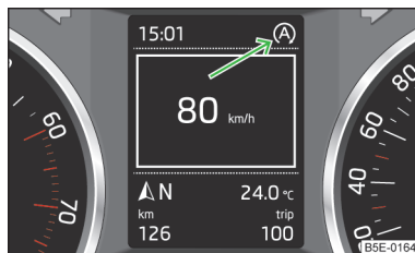
Илл. 144 Дисплей комбинации приборов: выключение двигателя (фаза Стоп)
