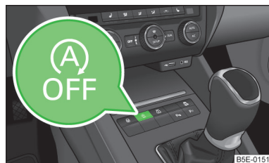
Илл. 146 Кнопка управления системой Старт-стоп.
