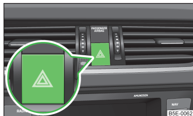
Илл. 34 Клавиша аварийной световой сигнализации.
