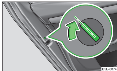
Илл. 17 Блокировка от случайного открывания задних дверей изнутри
