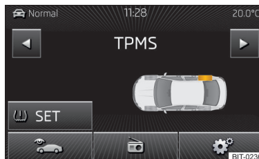
Илл. 22 Индикатор давления в шинах – пример индикации: проверить заднюю правую шину и давление в ней
