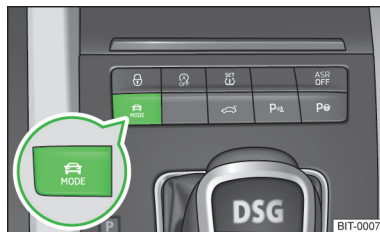
Илл. 11 Клавиша выбора режима движения на центральной консоли
